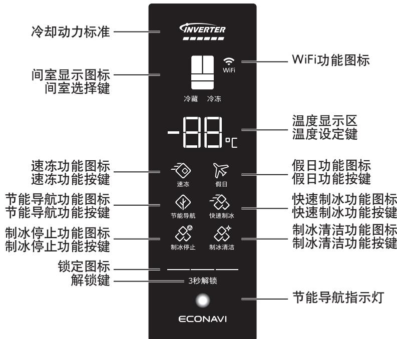
**冷却动力标准：**用于显示冰箱的冷却动力标准（压缩机转速）。
