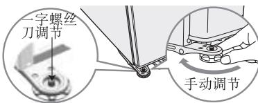
如果左右两个门不互相平齐，根据箭头方向调整较低一侧的调节脚，调节左右两门高度至水平状态。
