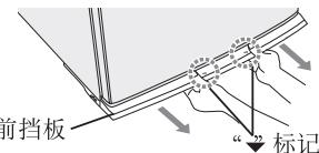
②按箭头方向调整左右调节脚，使其与地面接触牢靠，避免产生振动噪音。手动旋转困难时，可使用一字螺丝刀等工具进行调节。
