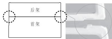
拆下突起，将前架里侧抬起后向前拉出。
