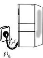
请勿损坏电源线或对其进行加工；请勿过度弯曲、拉伸、扭转、捆扎、重物重压；请勿将其靠近发热器具。
