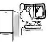
冰箱门开关等电触点的火星引起爆炸，有可能引起火灾和烫伤。
